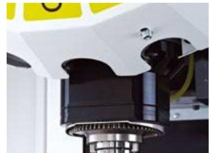
零背隙第四軸搭配馬達及控制器，以M信號起動或者以手動設定角度，達到NC 3軸+附加1軸。
