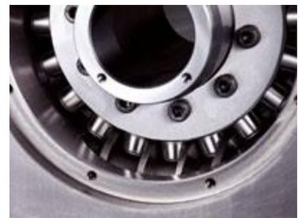
零背隙第四軸最高轉數可達80min<sup>-1</sup>。旋轉90°可於0.4sec內完成，可大幅縮短加工時間。
