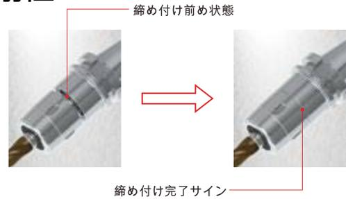
従来からの締め付けカラー端面密着方式 (2面拘束) により剛性が高く、ツヤソク部とチャック内径部の同心度は0.005mm以内に作られており、実用的に十分な振れ精度を維持しています。
