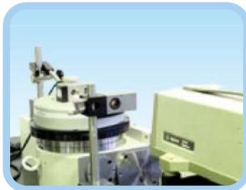
雷射干涉儀旋轉角度量測系統
